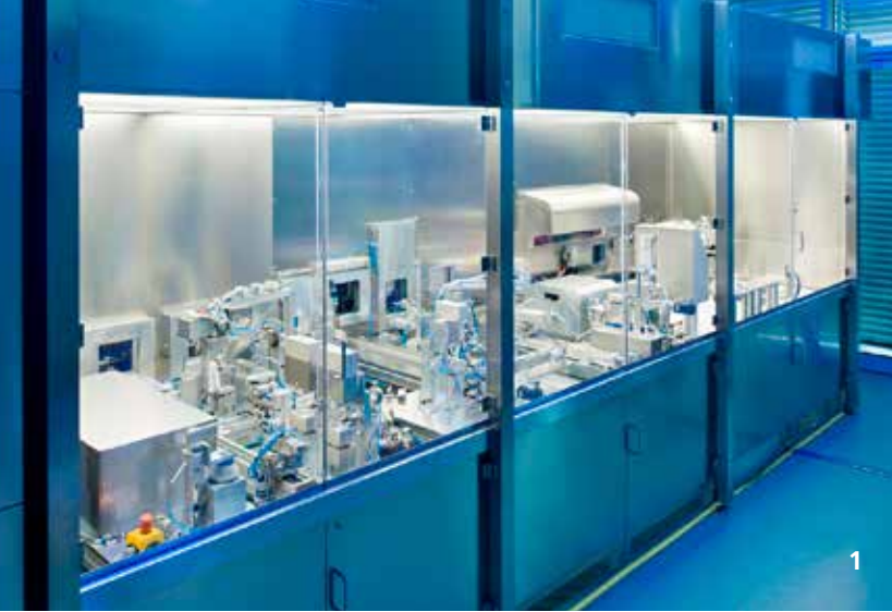
1 Automatisierte Herstellung von Gewebetests in der »Hautfabrik«.
